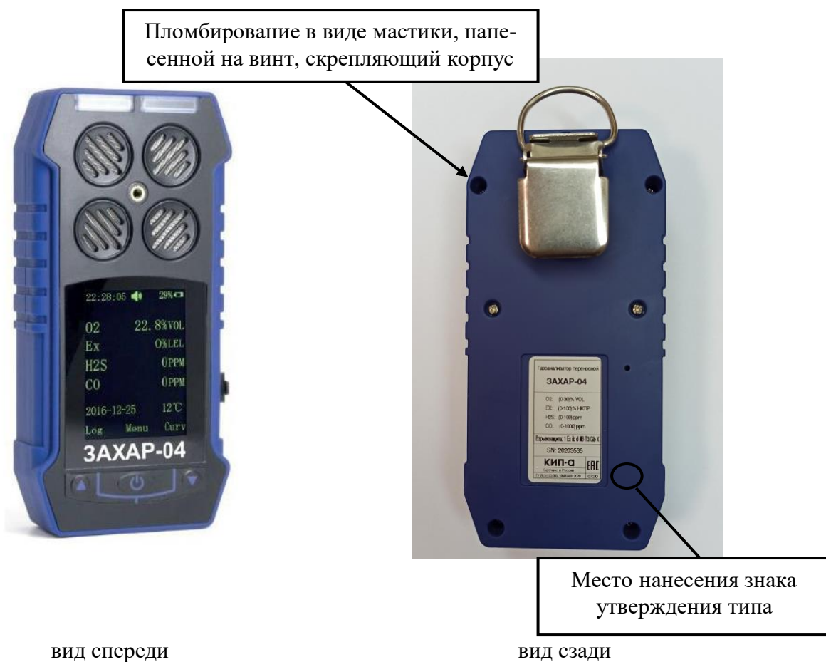
Рисунок 1 – Общий вид газоанализаторов переносных ЗАХАР-04 и место пломбирования корпуса от несанкционированного доступа
