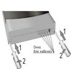
Рисунок 2 – Снятие крышки клеммного отсека
